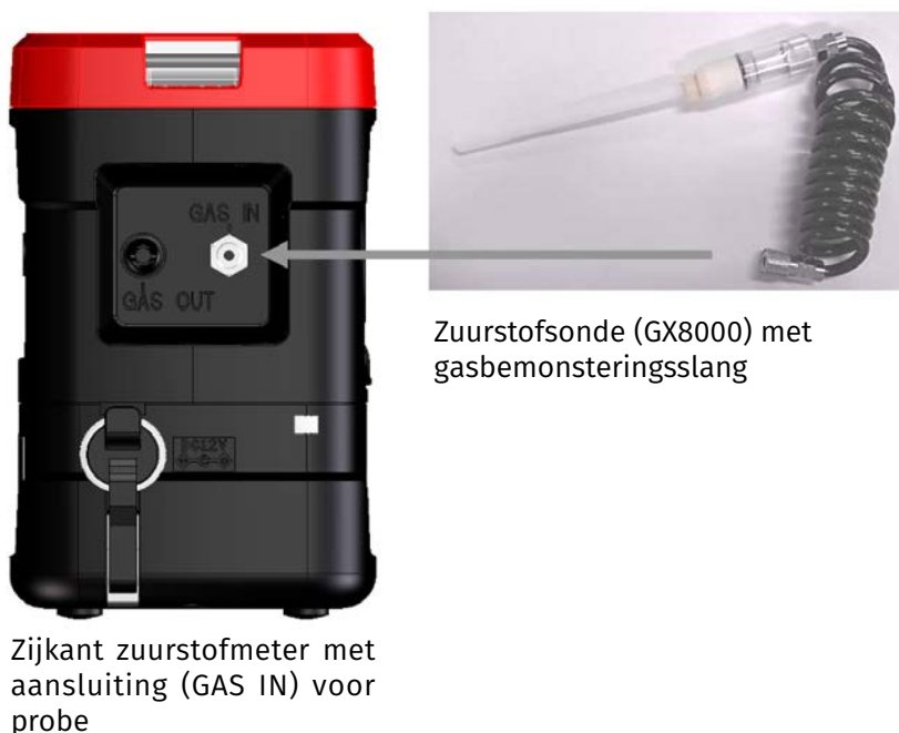
Fig. 3 Aansluiten zuurstof probe en bemonsteringsslang
