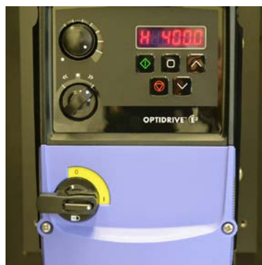
Fig. 8e Switch 3 set to the max 400 Hz
