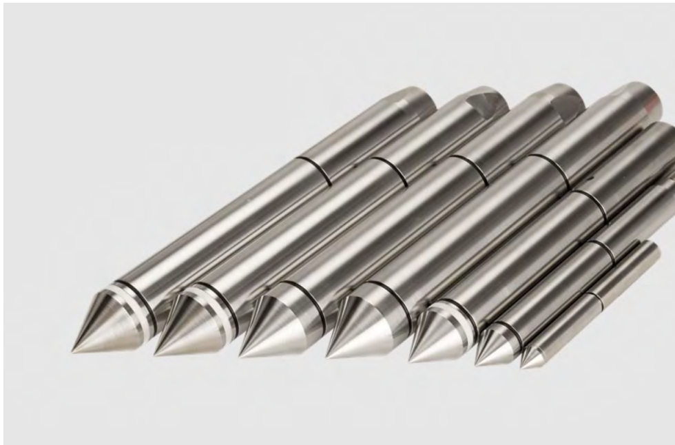
Figuur 5: Sondeerconussen, in maten van 15 cm 2 tot 2 cm 2
