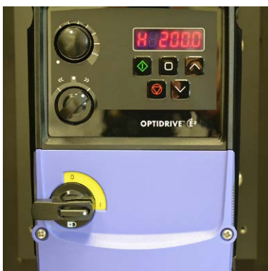
Fig. 8d Schakelaar 3 op 200 Hz
