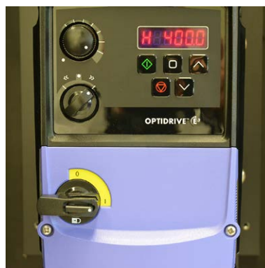
Fig. 8e Schakelaar 3 op max 400 Hz
