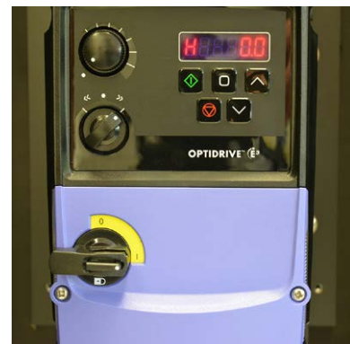
Fig. 8c Schakelaar 2 op >> (FWD)
