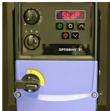
Fig. 8b Schakelaar 1 op ON
