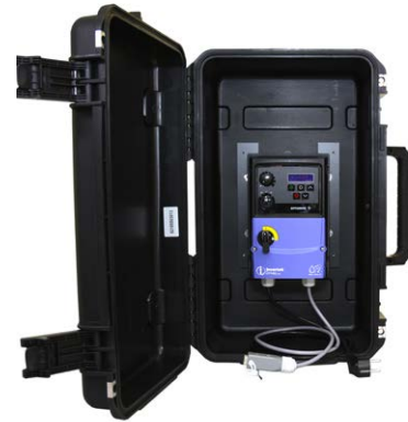
Fig. 7 Vertikale installatie van de omvormer
