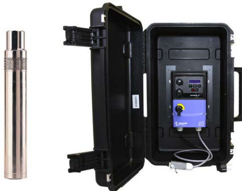
Fig. 1 Dompelpomp Grundfos MP 1 en frequentieomvormer
