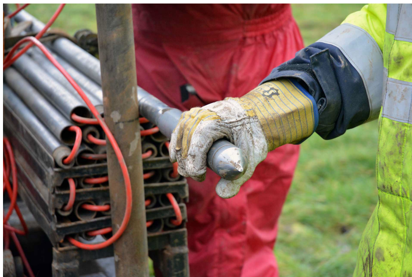
Figuur 1: Een sondering wordt uitgevoerd met een conus bevestigd op een reeks buizen
