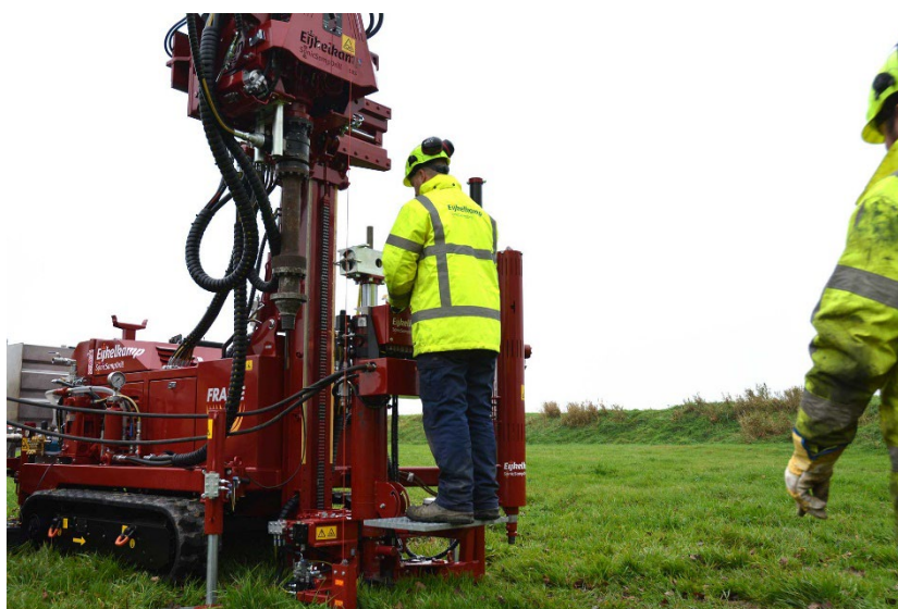
Figuur 2: Een toevoeging aan de boorinstallatie is een kosteneffectieve manier om sonderen te verkennen
