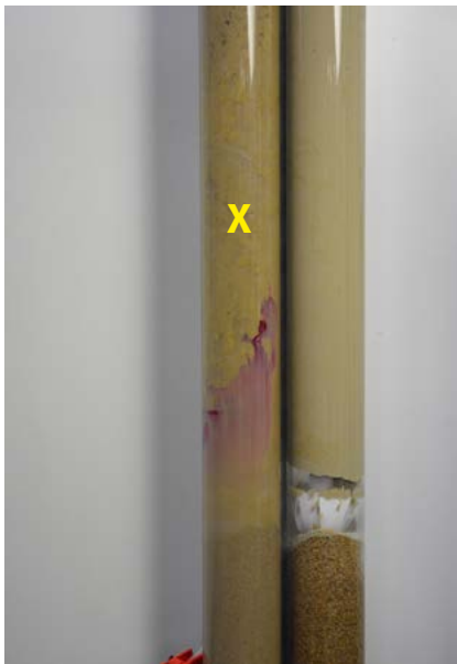
Product X vloeistof zakt bij afpompen door bentoniet.
