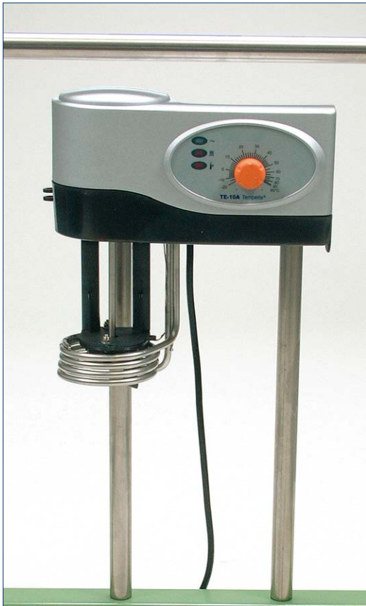
Figuur 3 Bevestiging verwarmingselement met roerapparaat
