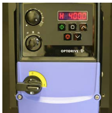
Fig. 8e Switch 3 set to the max 400 Hz
