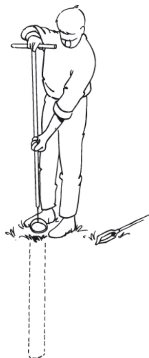
De snijschoen wordt uit het boorgat verwijderd.
